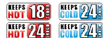
\*Performanța izolației este dată în ore. Se măsoară timpul în care temperatura băuturii se schimbă de la valoarea inițială la valoarea finală, temperatura mediului ambiant fiind de 20°C. Keeps Hot: Temperatura de pornire 45°C, temperatura finală 30°C. Keeps Cold: temperatura de pornire 1°C, temperatura finală 13°C.
